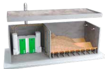
Heizzentrale mit 2er Kaskade
