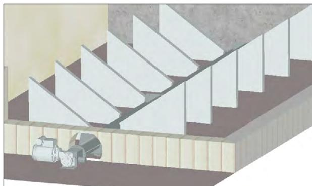
Pour la traversée du mur côté moteur, un manchon de laine de roche (livré avec la vis d'extraction) doit être mis autour de la vis afin de limiter la propagation des vibrations (cf. schéma ci-dessous).
