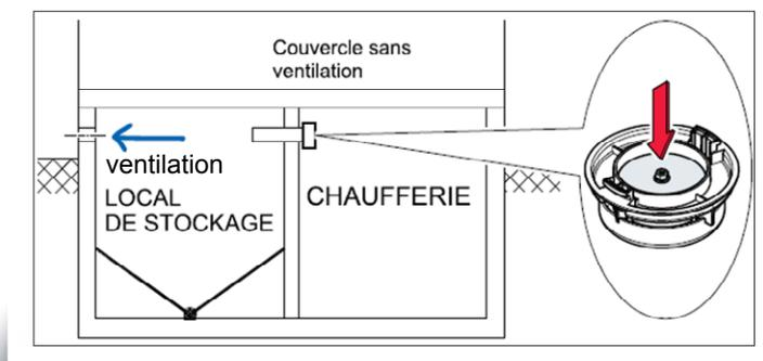
Raccord de remplissage ÖkoFEN SANS ventilation : laisser la plaque métallique.
