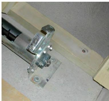
*La vis d'extraction en fond de silo doit être fixée au sol*
