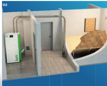
02 Stockage par pièce de réserve
