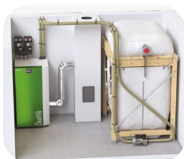
Stockage en silo textile
