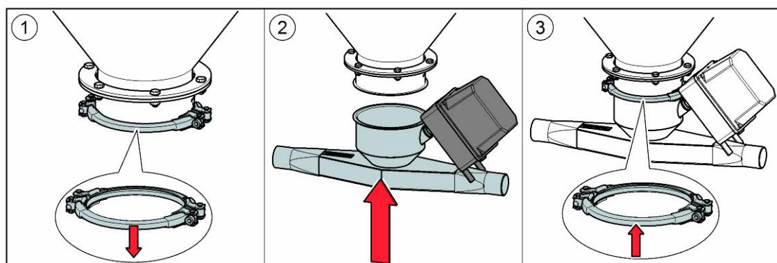
**Anschluss und Erdung der Pellets- und Luftleitung an das T-Stück – Connection and earthing of the pellet and air line to the T-piece**
