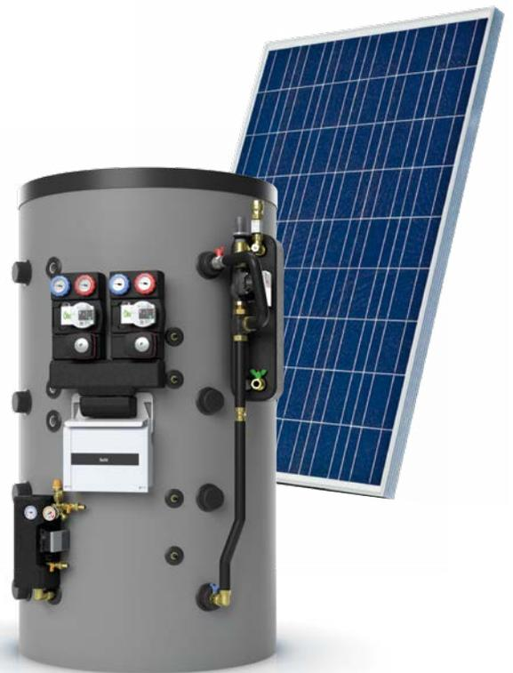
Der Smart PV besteht aus zwei Modulen. Dem **Smart PV Meter** und dem **Smart PV E-Heizstab** (3 kW). Der Smart PV Meter erkennt selbstständig die überschüssige Energie der Photovoltaikanlage (oder einer anderen Stromproduktion) und aktiviert den E-Heizstab je nach Leistung.
