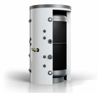
Systemspeicher FWWP mit 800 l oder 1000 l für perfekte Schichtung & netzdienlichen Betrieb, Absperrung für Kühlung inkl., Energieeffizienzklasse C, optional auch mit Solarregister
