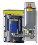
Die Regelung der Feuerung erfolgt über die Kesselsteuerung, welche in Kombination mit einem Verbrennungsluftgebläse, dem Kesselfühler und dem Feuerraumfühler sowie mit einem Brennraumdrucksensor die Wärmeleistungserzeugung regelt, überwacht und optimiert.
