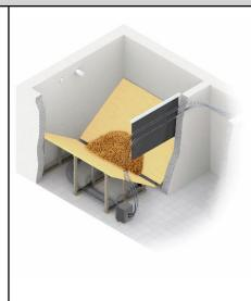
Die max. Förderlänge (Umschalteinheit bis Kessel) beträgt 15 m und die max. Förderhöhe beträgt 3 m. Für eine möglichst hohe Funktionssicherheit ist der Einbau eines Schrägbodens unabdingbare Voraussetzung. Bei Verwendung des Entnahmesonden-Saugfördersystems ohne Schrägboden besteht kein Garantieanspruch. Da sich am Boden Pelletsstaub absetzt sind bei diesem System eine vollständige Entleerung des Lagerraums und eine Reinigung (Entfernung des Pelletsstaubs) min. alle 2 Jahre notwendig.
