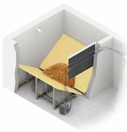
Die max. Förderlänge (Umschalteneinheit bis Kessel) beträgt 15 m und die max. Förderhöhe beträgt 3 m. Für eine möglichst hohe Funktionssicherheit ist der Einbau eines Schrägbodens unabdingbare Voraussetzung. Bei Verwendung des Entnahmesonden-Saugfördersystems ohne Schrägboden besteht kein Garantieanspruch. Da sich am Boden Pelletsstaub absetzt sind bei diesem System eine vollständige Entleerung des Lagerraums und eine Reinigung (Entfernung des Pelletsstaubs) min. alle 2 Jahre notwendig.
