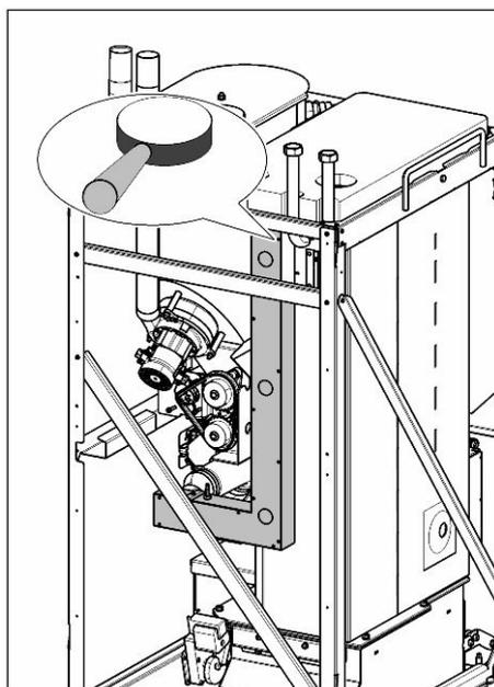
Prüfen der Zuluftleitung auf freie Durchgängigkeit. Zuluftleitung wieder mit Kesseldeckel verbinden und Verbindung auf Dichtheit kontrollieren!
